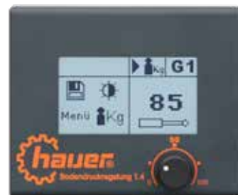
Krmilnik z zaslonom na dotik in potenciometrom
