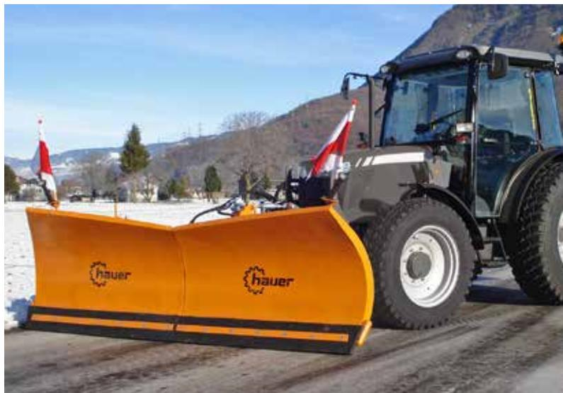
De par l'extrême robustesse de sa conception, la série d'étraves à neige HS est non seulement adaptée au déneigement léger de voies et places publiques, mais également au nivellement de terre meuble, de sable ou de gravier. Disponible en option, la lame racleuse en caoutchouc réduit considérablement le bruit et l'usure au travail.
