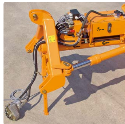
externe Ölversorgung mit Zapfwellenpumpe und Öltank
