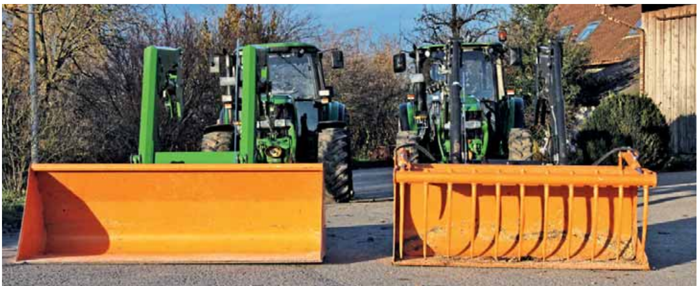
Der Holmquerschnitt an POM-VX-Ladern (rechts) war rechteckig, an den neuen XB-Bionic-Ladern bildet er ein Fünfeck.
